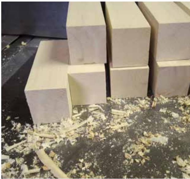
**Herstellung/Erster Schritt** Der fachkundige Handwerker bearbeitet die Holzblöcke mit dem Pantografen. Somit entstehen die Rohlinge, die nun Stück für Stück weiter bearbeitet werden.
